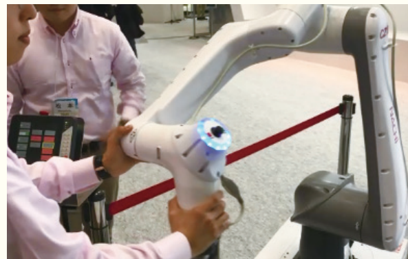
CZ-10へのダイレクトティーチング
